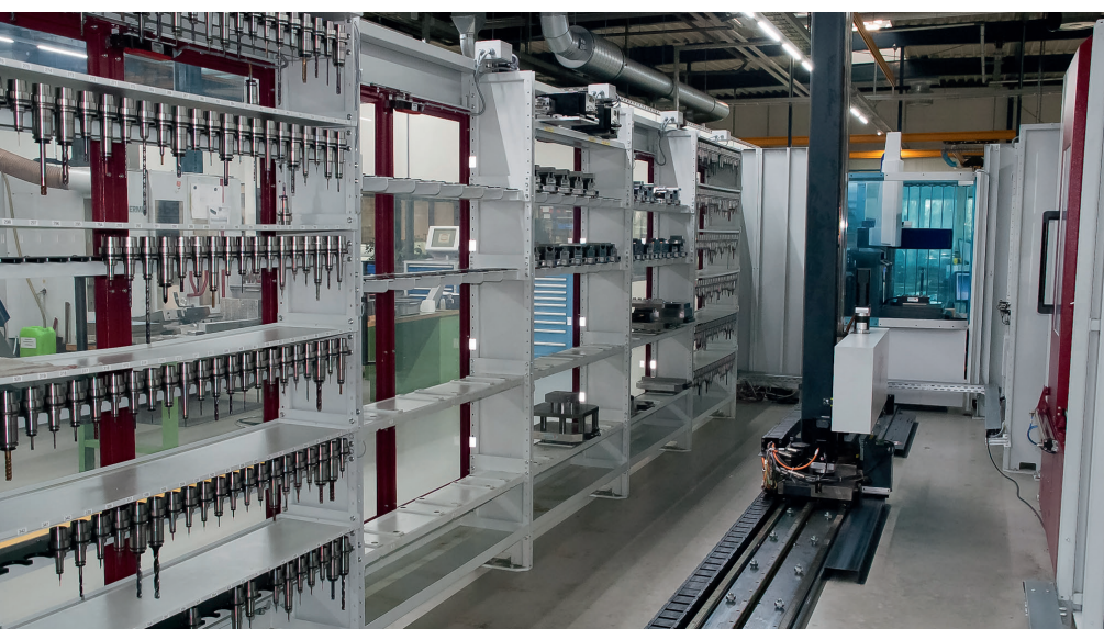
Automatisierte Fertigungszelle: Der Linearroboter der Fertigungszelle sorgt dafür, dass die beiden 5-achsigen Rōders RXP60IDSH rund um die Uhr komplett ausgelastet sind. Der Zentrumspringer (Lang) gewährleistet, dass das Werkstück bei der Bearbeitung nicht verschoben wird. (© MMC Hitachi Tool)
